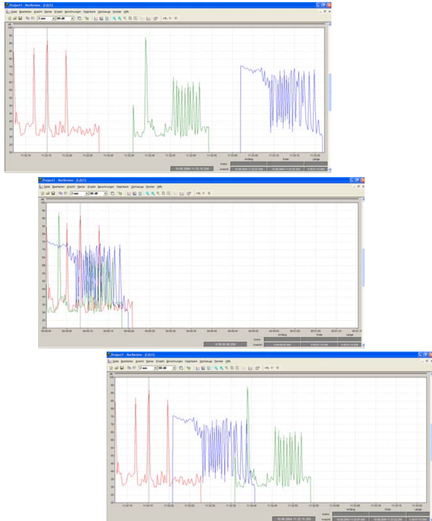
Drei verschiedene Messdateien dargestellt entlang der absoluten Zeitachse (oberes Diagramm) und entlang der relativen Zeitachse (mittleres Diagramm). Durch das Anpassen der Startposition mit einem negativen Offset wird die dritte Messdatei an einer neuen Position entlang der absoluten Zeitachse dargestellt (unteres Diagramm).
