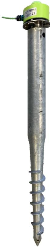
Diese einfach zu montierenden Schraubfundamente mit Nivellier-Adapterplatte für Menhir-Sensoren bieten neben einfacher Handhabung einen festen Sitz in weichem Untergrund und somit bestmögliche Verlässlichkeit vom Erschütterungsmessungen auf weichem Untergrund, wie sie etwas für Eisenbahn-Erschütterungsmessungen durchgeführt werden.
