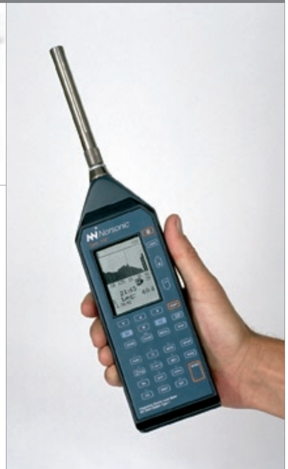
Nachhallzeitmessung in Oktav und Terzbändern
